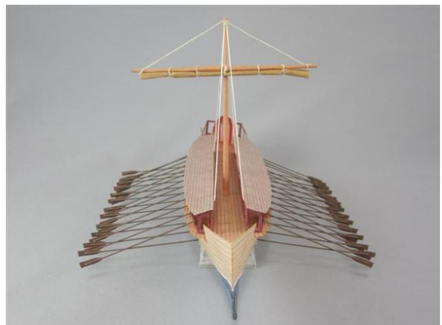
Römische Flussschiffe wurden gerudert, getreidelt oder gesegelt. In diesem Bastelbogen wird eine Flussliburne vorgestellt, wie sie von den Römern auch auf Donau und Rhein eingesetzt wurde.
