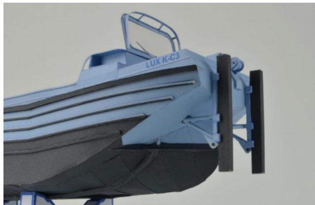
Für die Verlastung musste das Boot so kompakt sein, dass es auf dem Land zum Einsatzort gebracht werden konnte. Dies konnte mit dem speziell entwickelten zweirädrigen Anhänger SW B5/70 erfolgen, mit dem das 4800 kg schwere Boot geslippt werden konnte. Als Zugfahrzeuge waren hier 5t und 7t LKWs vorgesehen, jedoch konnte das Boot auch samt Anhänger auf Waggons verladen werden.
