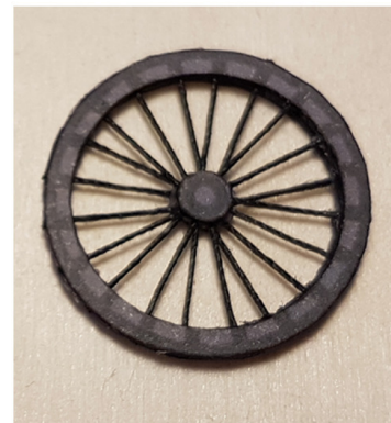
Radnaben mit 0,3mm Finn- oder Graupappe verstärken und aufkleben.
